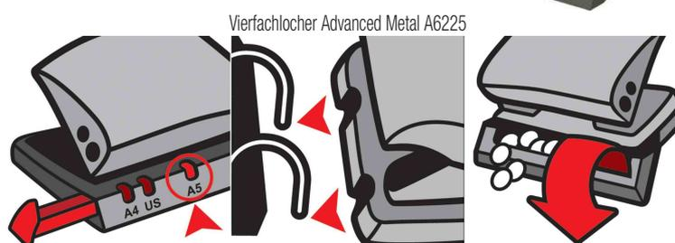
Anschlagsschiene - System zum Zentrieren - Entleerungsklappe
