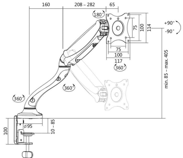
TFT- / LCD-Monitorarm - Abmessungen
