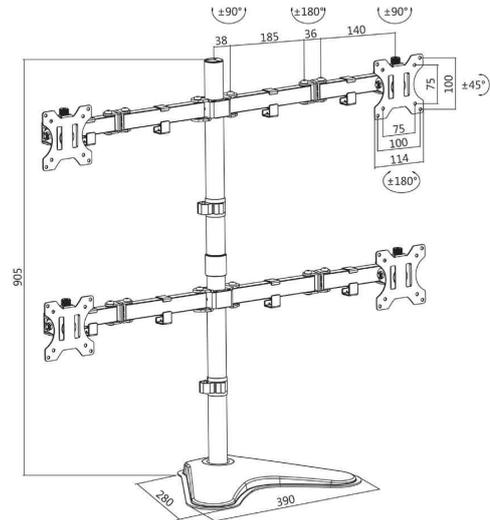
TFT-/LCD-Monitorarm mit Standfuß - Abmessungen
