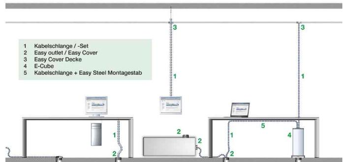
zeigt die Verkabelungsmöglichkeiten der Kabelschlange
